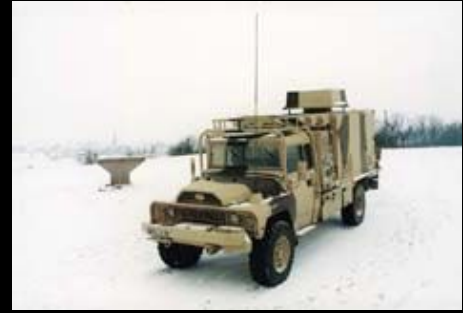
Véhicule COMINT de type START de l'Armée de Terre française tel que celui-ci affecté au 54e R.T. Ce matériel est projetable sur un théâtre extérieur
